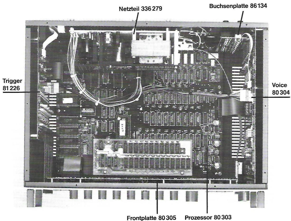
Fehler im Digitalteil der Prozessorplatine können meistens nur mit teuren Meßinstrumenten (68009-Emulator, 16-Kanal Logik analysator und 100 MHz-Oszilloscope) gefunden werden. Es ist deshalb ratsam, diese Platine ins Werk zur Reparatur einzuschicken. Bitte genaue Fehlerbeschreibung beilegen!
